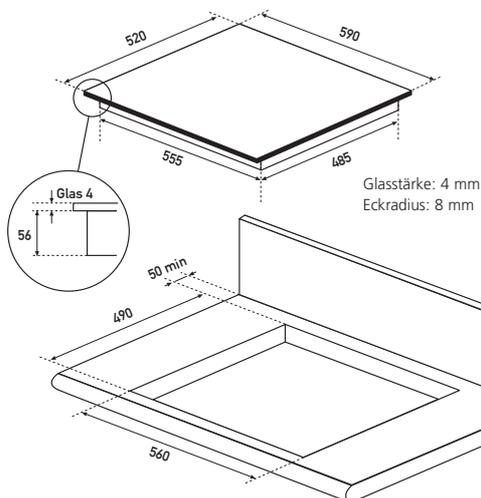
Für den flächenbündigen Einbau umlaufend
