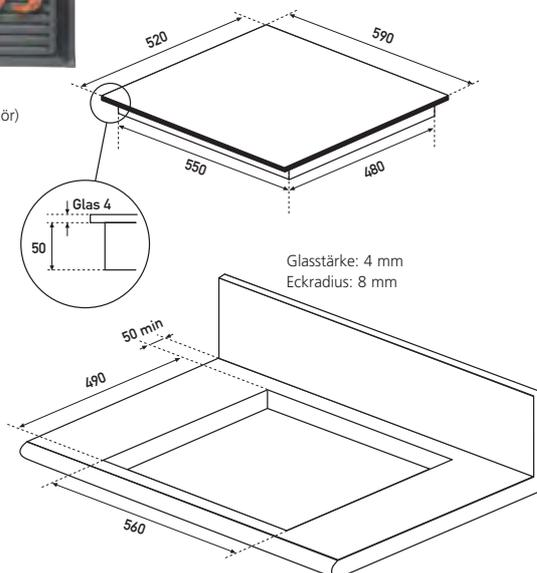
Für den flächenbündigen Einbau umlaufend min. 1,8 mm für die Silikonfuge berücksichtigen. Falzhöhe 7 mm
