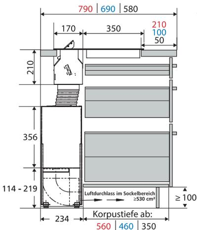
\* Die Planungsbeispiele dienen der Illustration. Bitte beachten Sie die Unterschiede der jeweiligen Möbelhersteller. Der Motor ist um 180 Grad drehbar und in der Richtung verschiebbar. APL ab 16 mm möglich.
