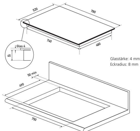
Für den flächenbündigen Einbau umlaufend
