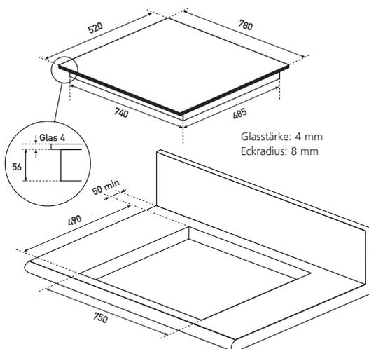
Für den flächenbündigen Einbau umlaufend min. 1,8 mm für die Silikonfuge berücksichtigen. Falzhöhe 7 mm
