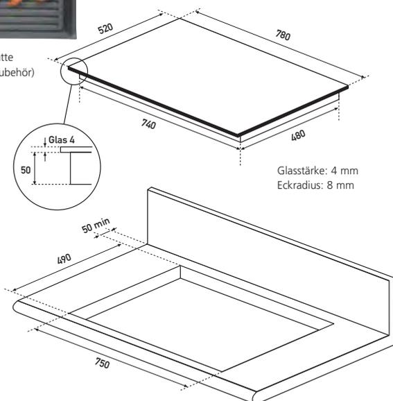
Für den flächenbündigen Einbau umlaufend min. 1,8 mm für die Silikonfuge berücksichtigen. Falzhöhe 7 mm
